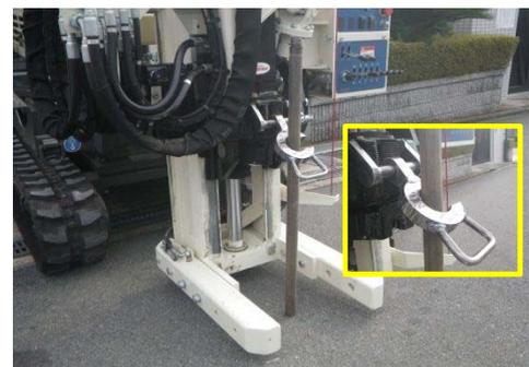
写真-5 ロッド引抜き用トング
