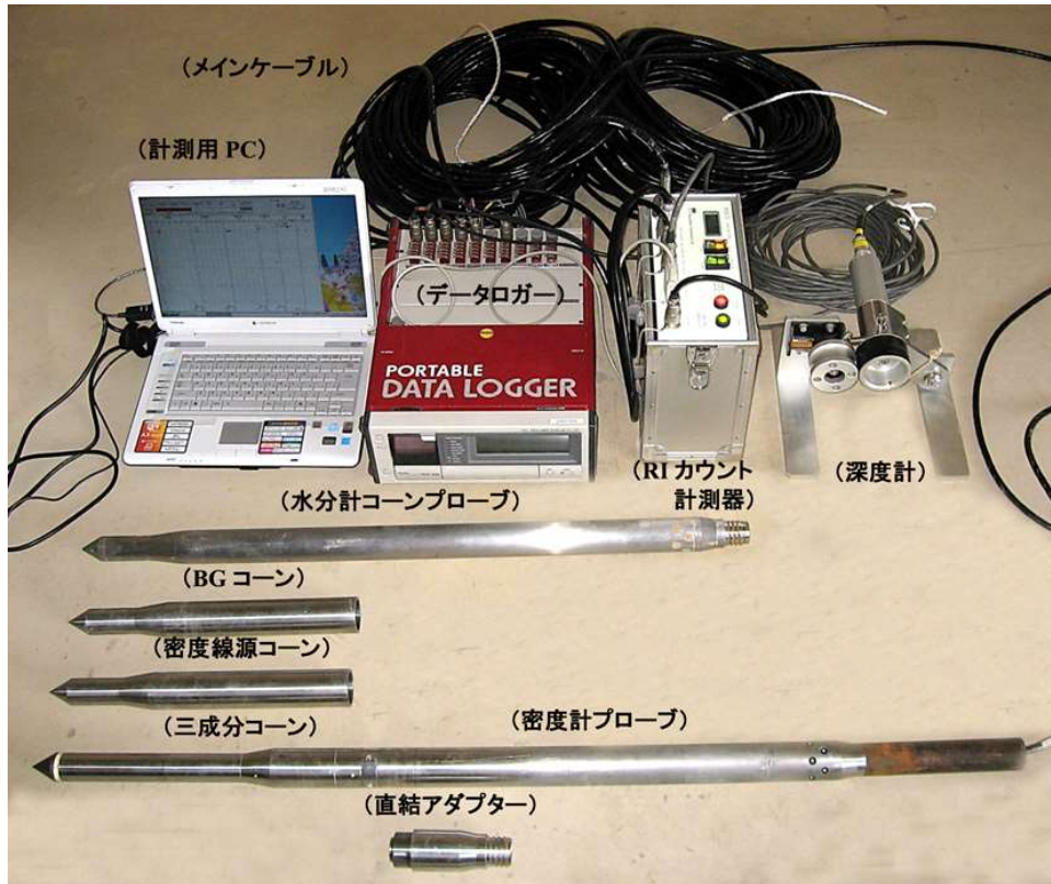
図-2.4 RI コーンプローブと測定システム
